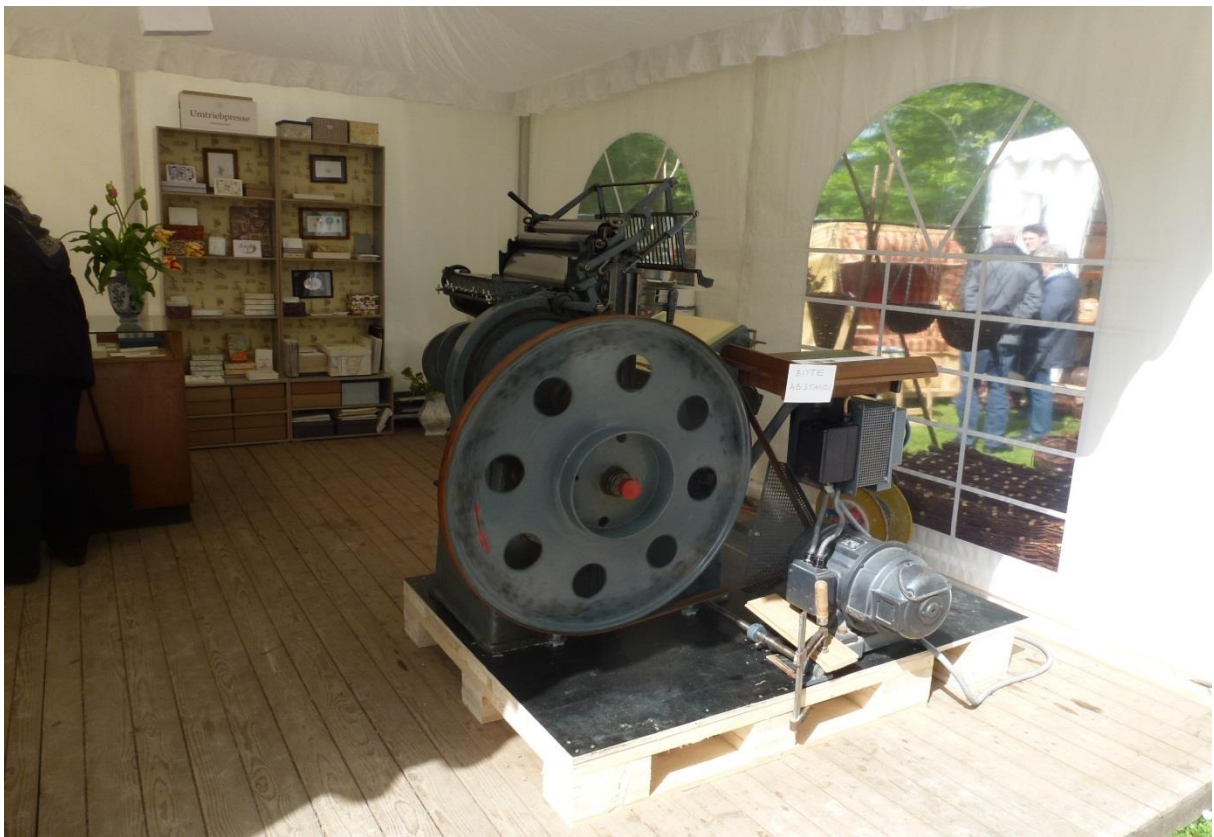
Abb. 20: Buchdruckmaschine auf lastverteilernder Unterkonstruktion. (v. Hoeren, 2012)
