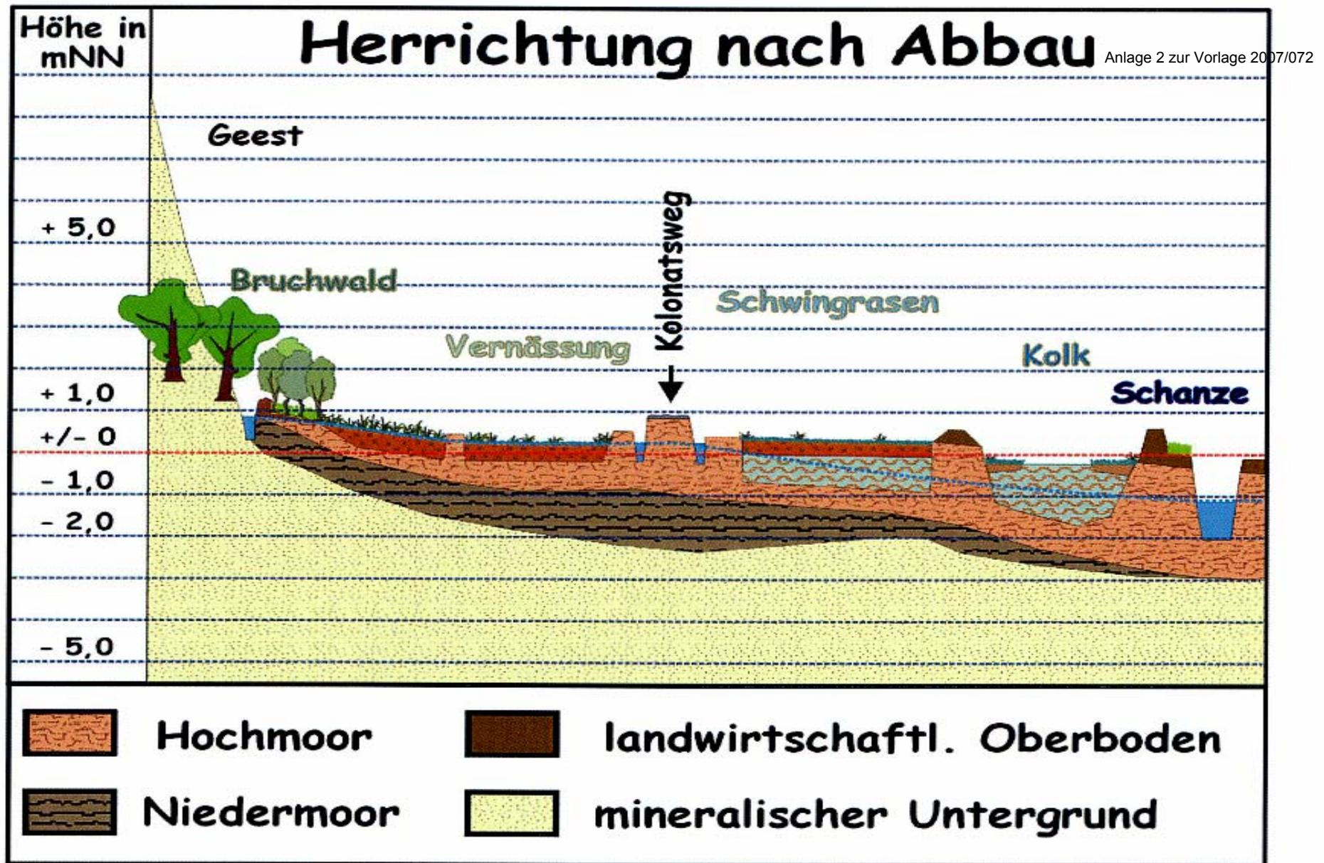
Abbildung 38: Szenario "Torfabbau" – Herrichtung nach Abbauende (schematischer Querschnitt)
