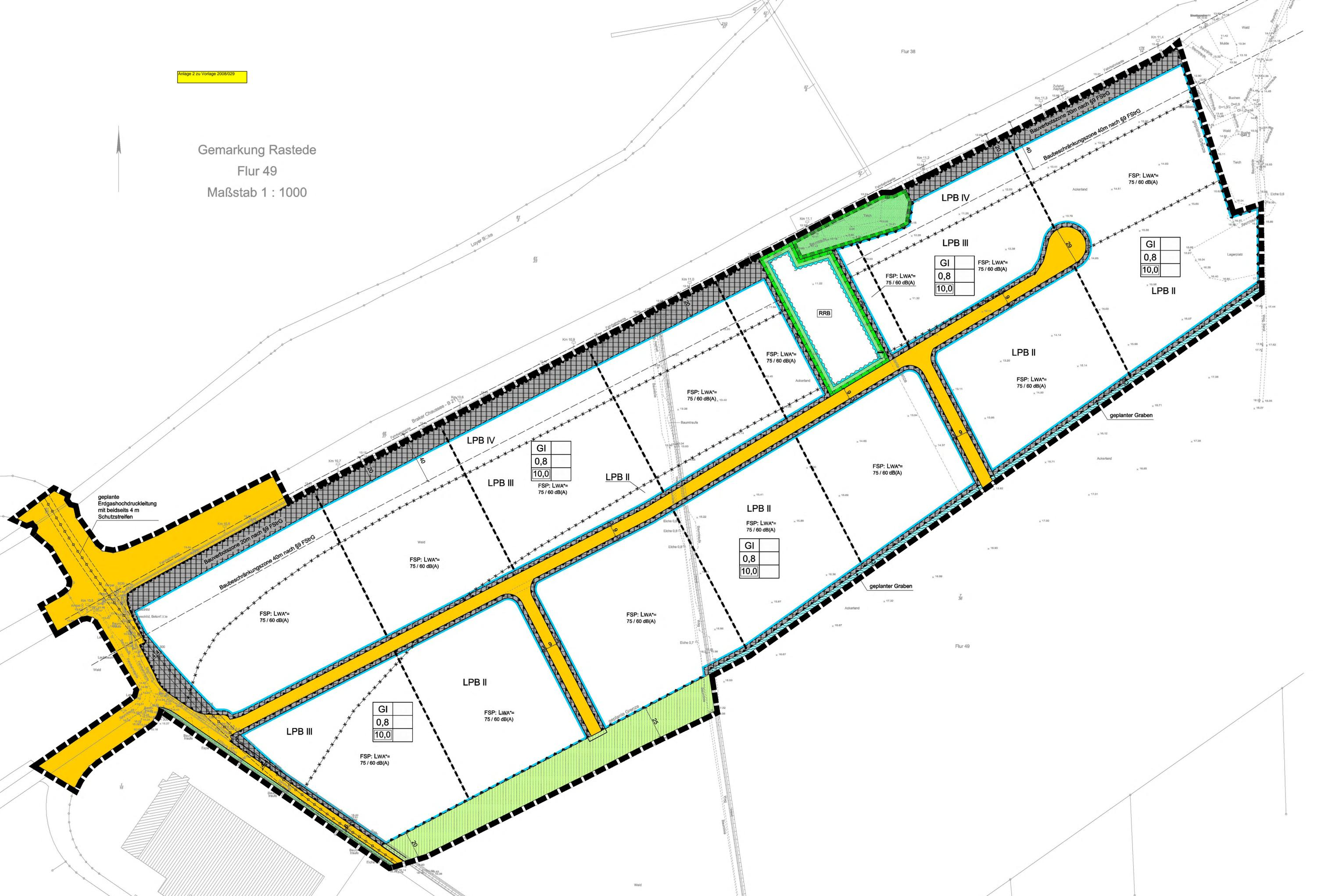
geplante Erdgashochdruckleitung mit beidseitig 4 m Schutzstreifen
