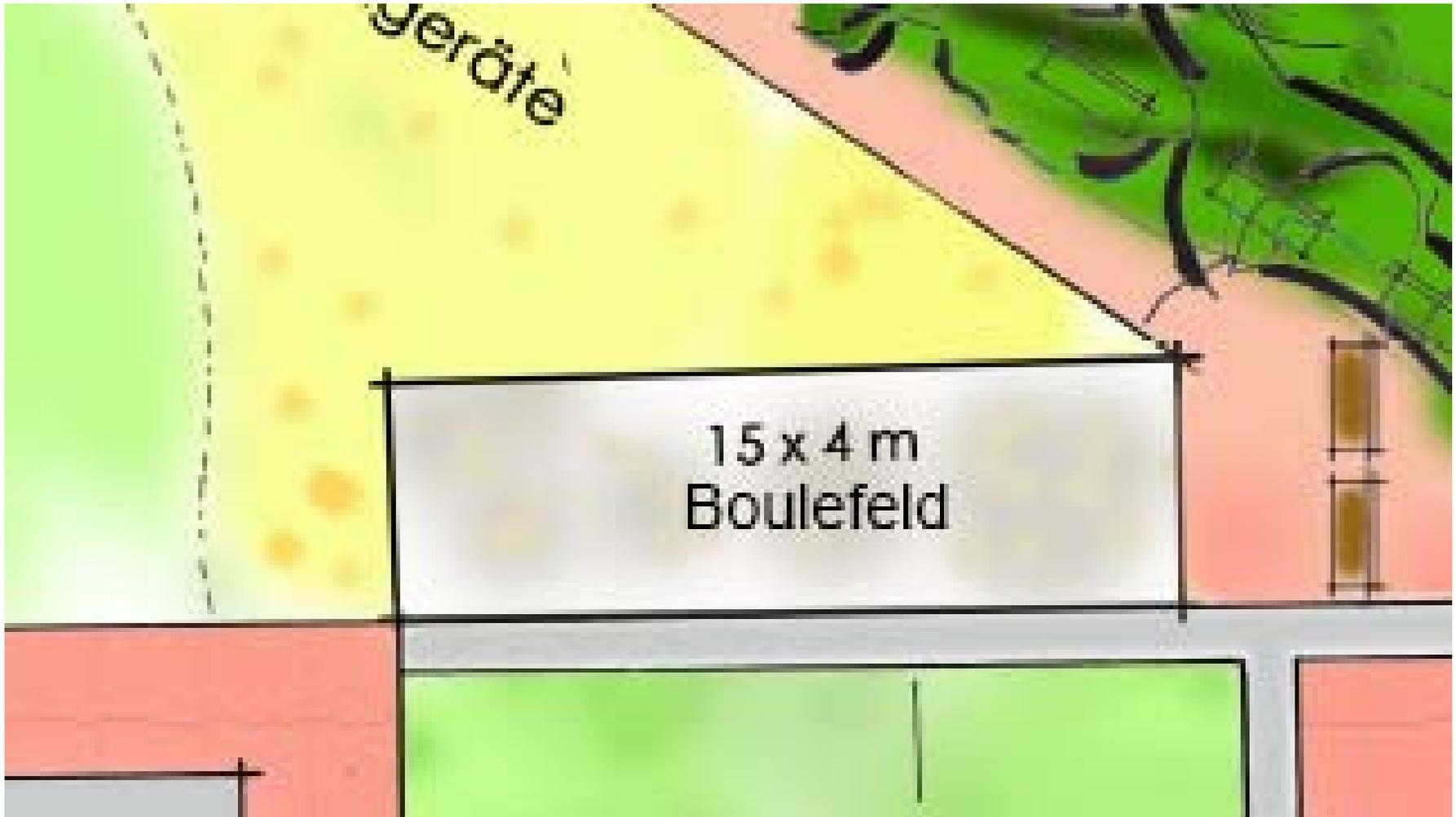
Das Boulefeld ist überbaubar. Die Einfassung aus Kunststoffbalken kann entfernt werden. Die Oberfläche besteht aus einer wassergebundenen Decke.
