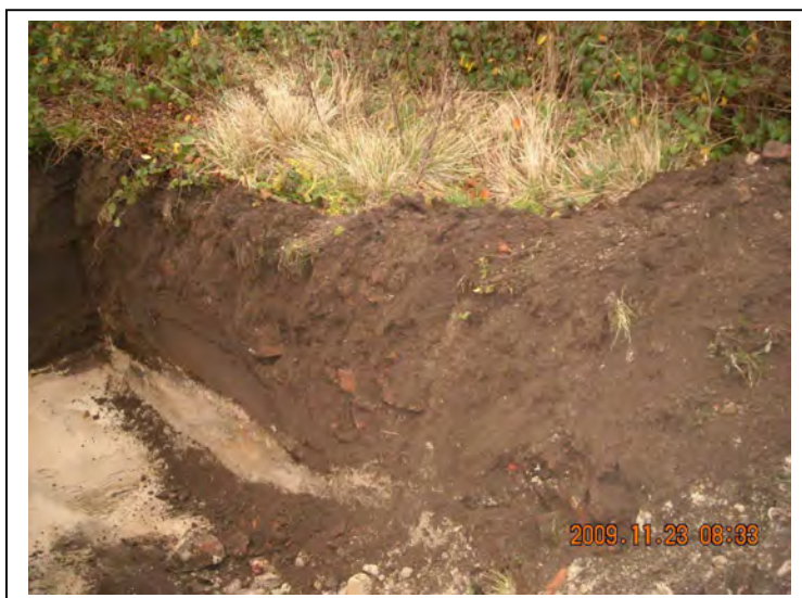
Bild 3: Schurf 3, südliche Freifläche (Auffüllung mit Bauschutteinlagerung)
