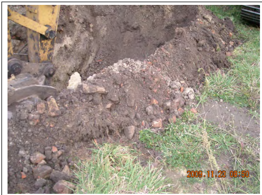
Bild 5: Schurf 5, südliche Freifläche (Auffüllung mit Bauschutteinlagerung)
