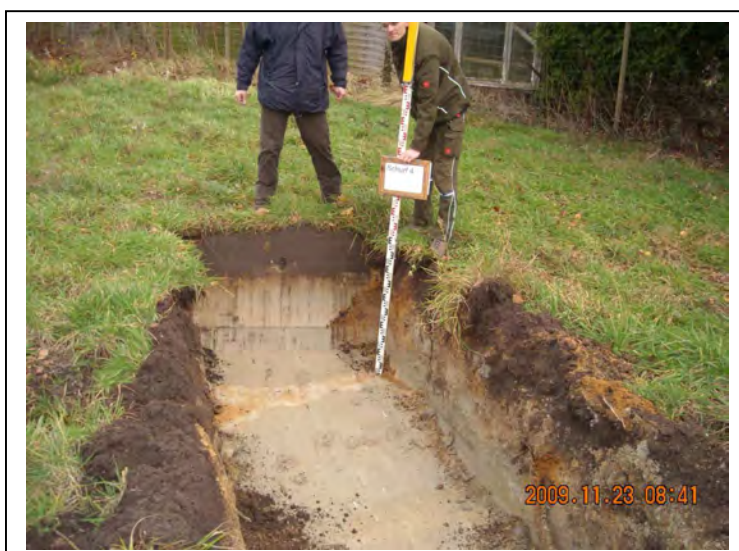
Bild 4: Schurf 4, südliche Freifläche (Mutterboden über gewachsenem Boden)
