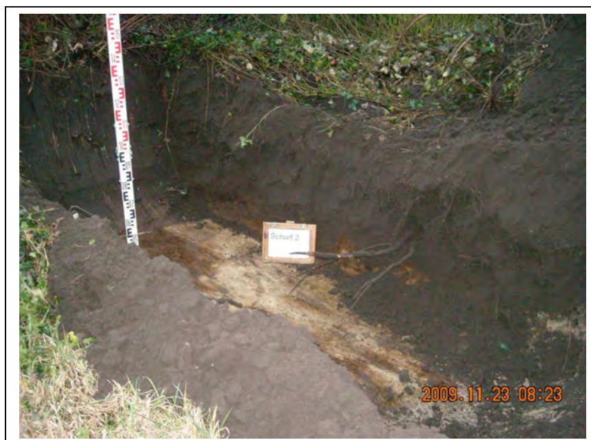
Bild 2: Schurf 2, südliche Freifläche (Mutterboden über gewachsenem Boden)
