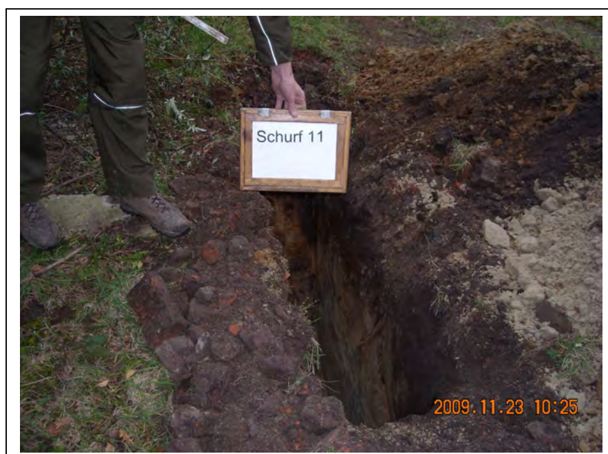
Bild 10: Schurf 11, Wegebereich vor „Tanklager“ (Bauschutteinlagerung)
