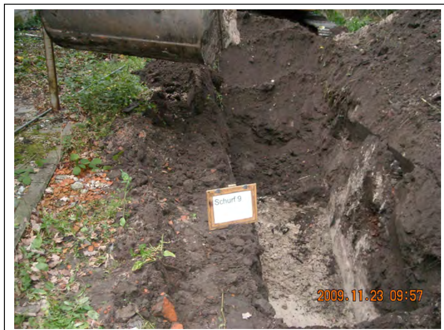
Bild 9: Schurf 9, nördliche Grundstücksgrenze (geringe Bauschutteinlagerung)
