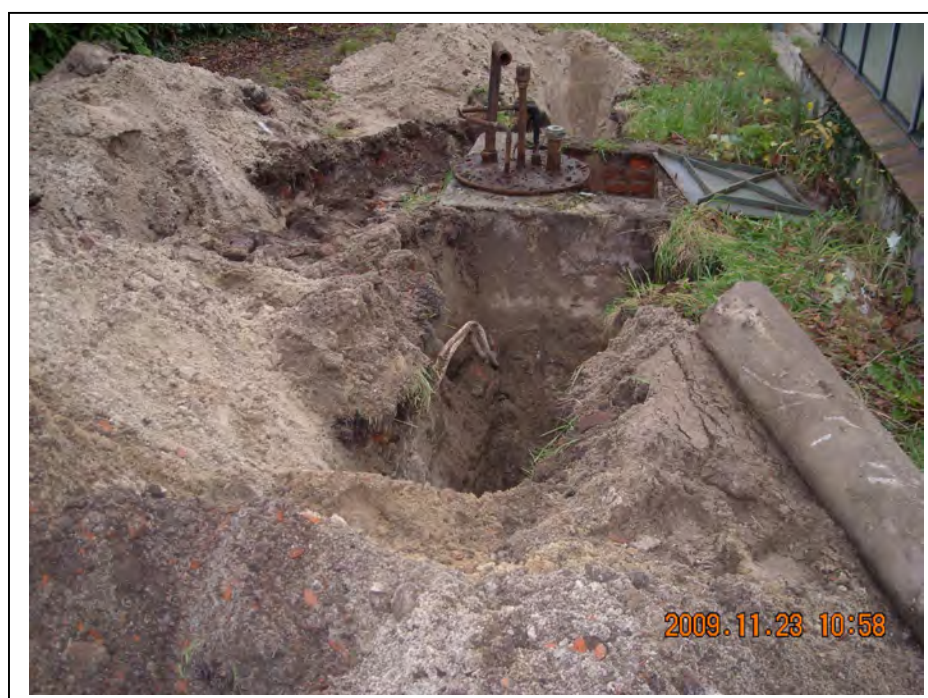
Bild 12: Schurf 13, Erdtank vor Gewächshäusern (Wegebereich mit Bauschutteinlagerungen)
