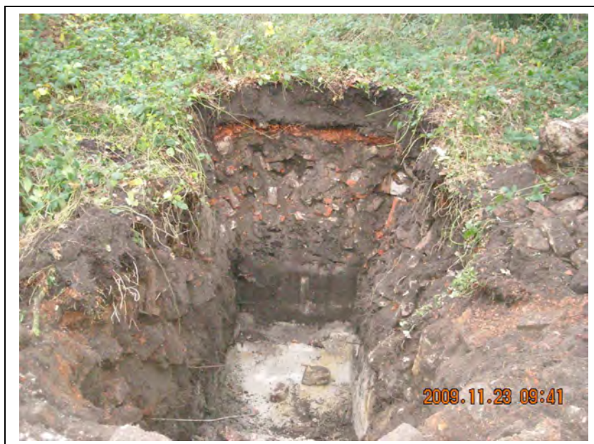
Bild 8: Schurf 7, nördliche Grundstücksgrenze (Bauschutteinlagerung)
