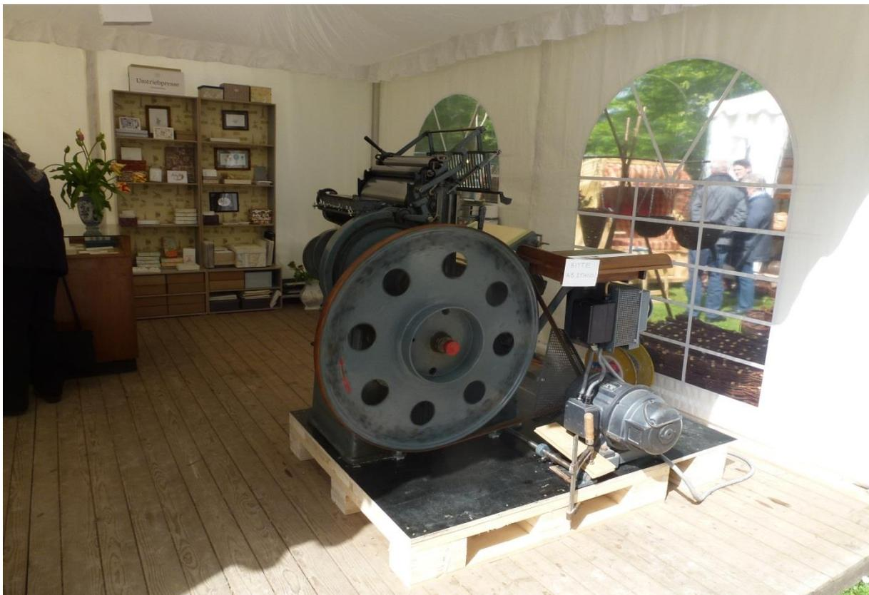
Abb. 20: Buchdruckmaschine auf lastverteilernder Unterkonstruktion. (v. Hoeren, 2012)
