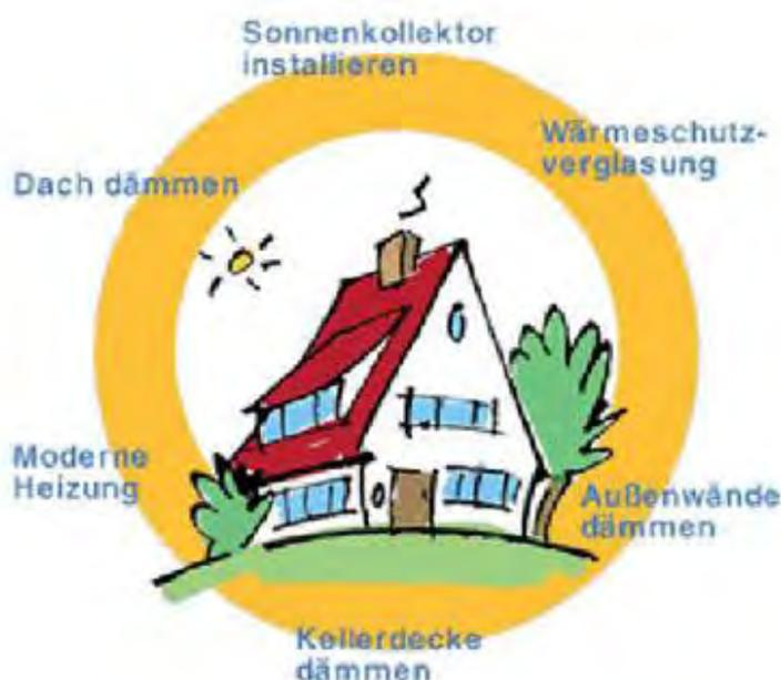
Abb.: Übersicht der Möglichkeiten der energetischen Gebäudesanierung
