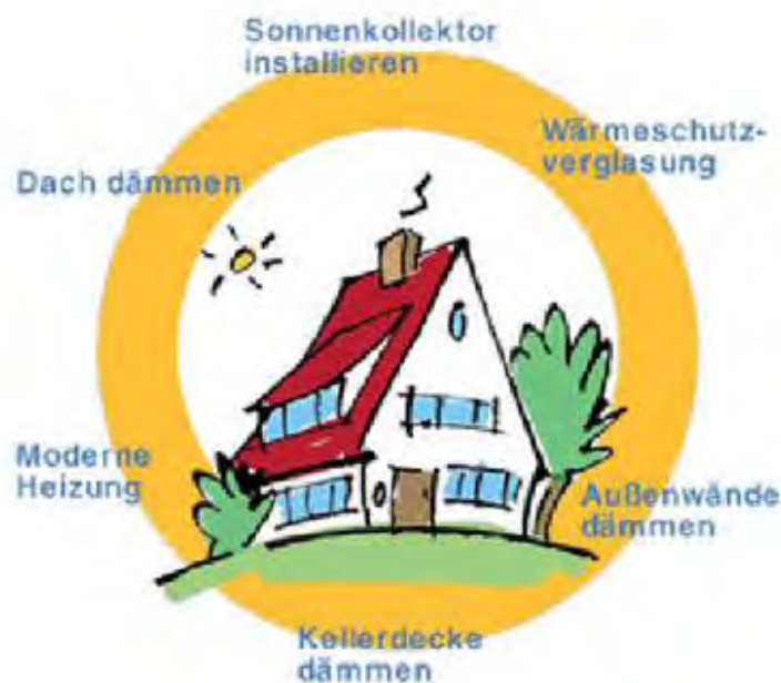
Abb.: Übersicht der Möglichkeiten der energetischen Gebäudesanierung
