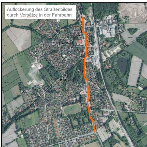
Abb.: Auflockerung des Straßenbildes durch Versätze in der Fahrbahn für die Ortsdurchfahrt Hahn-Lehmden
