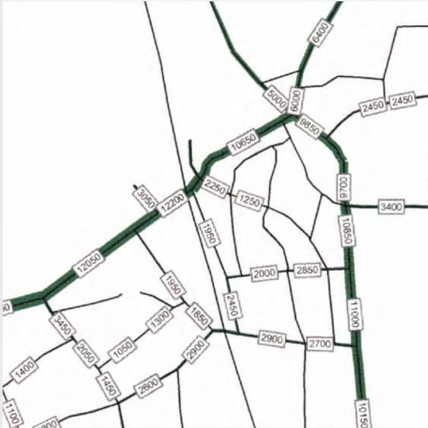
1999 - Durchschnittlicher werktäglicher Verkehr (DTVw) in Kfz/24h
