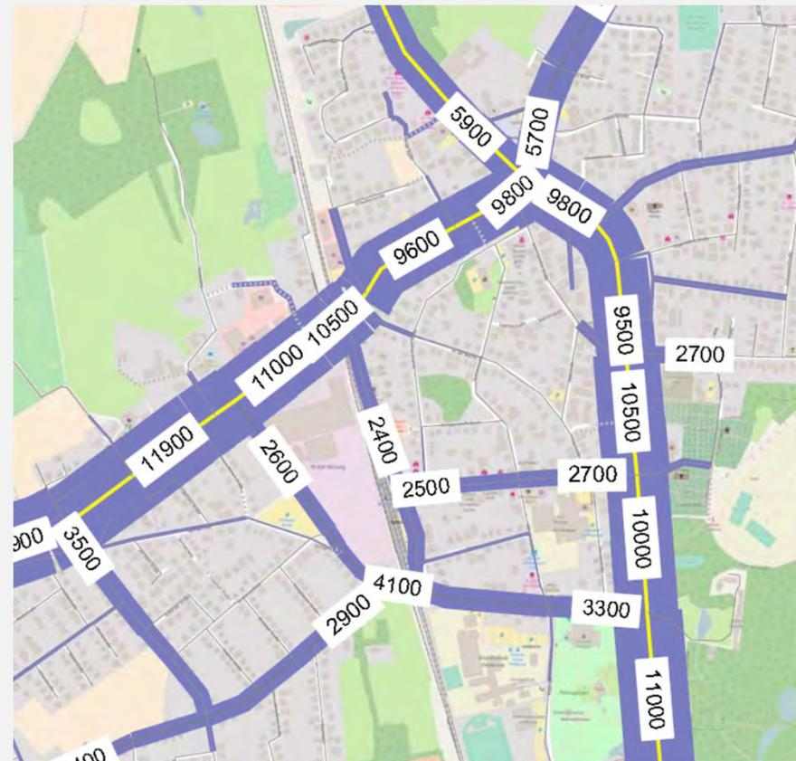
2017 - Durchschnittlicher täglicher Verkehr (DTV) in Kfz/24h
