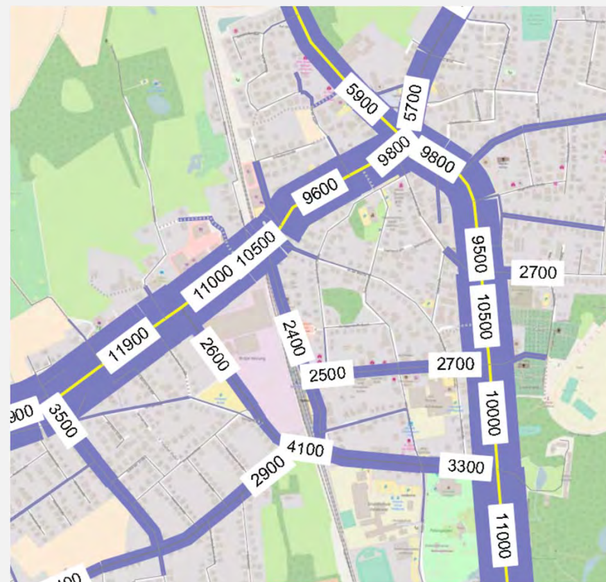
2017 - Durchschnittlicher täglicher Verkehr (DTV) in Kfz/24h
