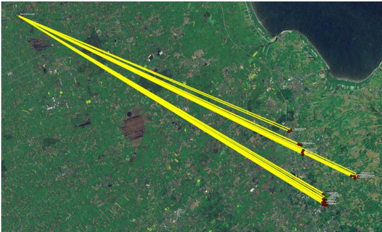
Abbildung 1: Grafische Übersicht auf die gekennzeichneten Windenergieanlagen (rot=Bestand, grün=Planung). Die Einstrahlungsrichtungen bzgl. des Radars Brockzetel sind durch gelbe Linien gekennzeichnet. Das Planungsgebiet ist im rechten unteren Bildbereich zu sehen.
