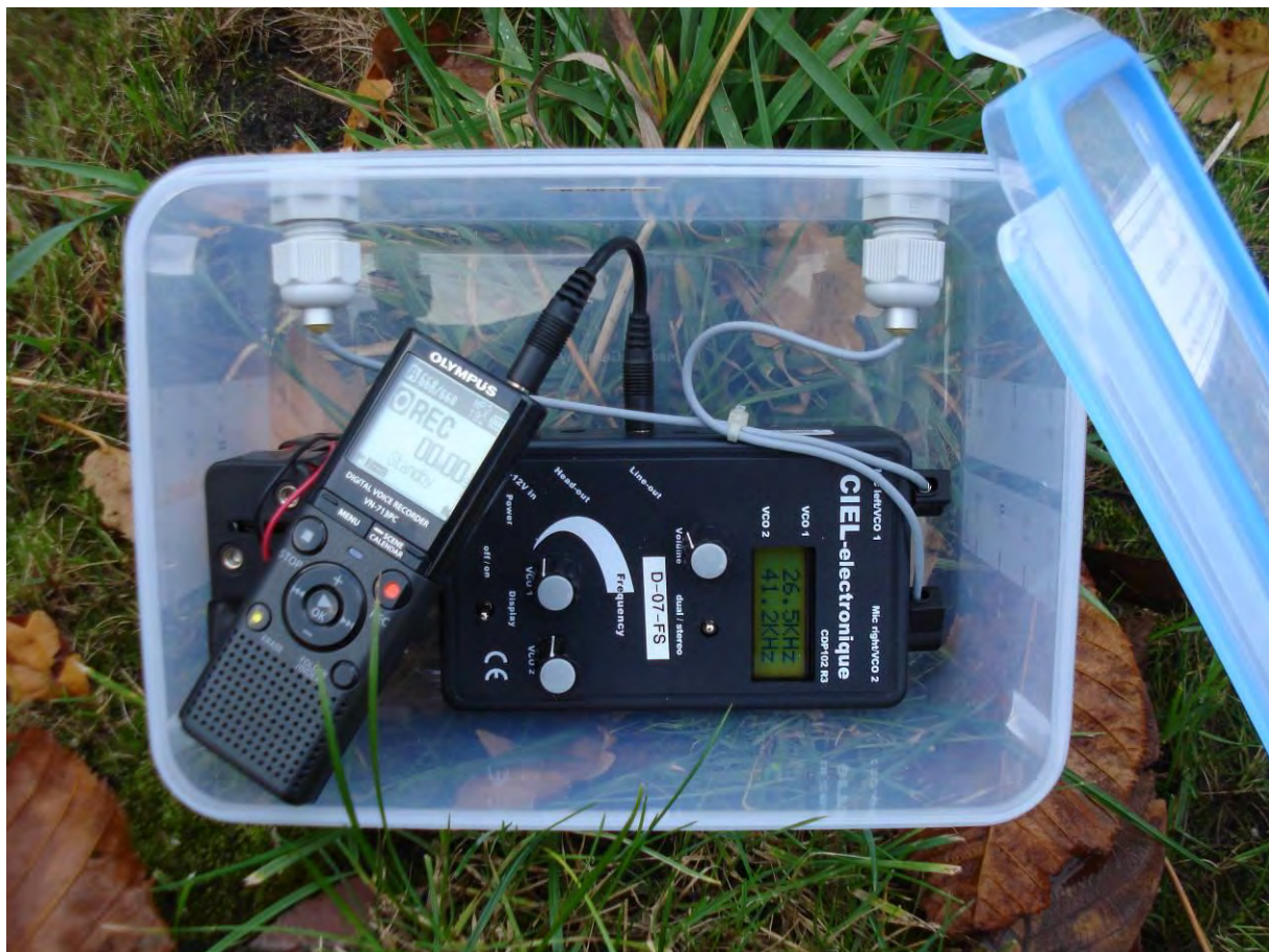
Abbildung 1: Schematischer Aufbau einer Horchkiste
