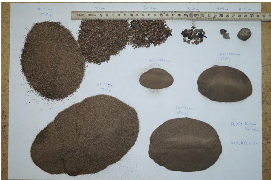
Bild 9) Fraktionierte Rasentragschicht von B2 (oberer Horizont)
