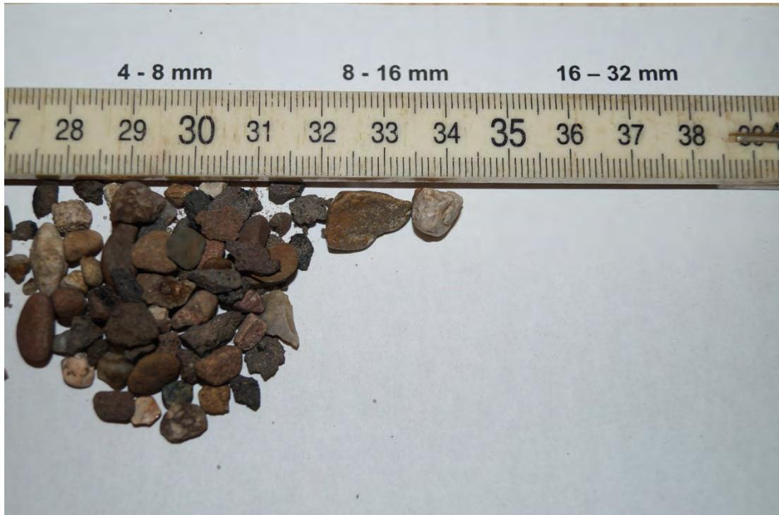
Bild 10) Fraktionierung Rasentragschicht B1 (oberer Horizont) Korngröße 4 – 8 mm
