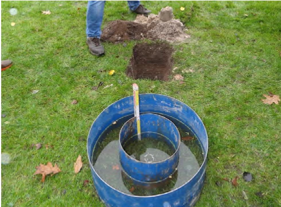
Bild 1) B1: Doppelringinfiltrometer mit Messspitzen und Metermaß, Handschurf
