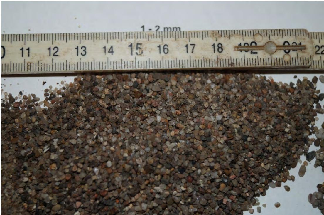
Bild 12) Fraktionierung Rasentragschicht B1 (oberer Horizont) Korngröße 1 – 2 mm
