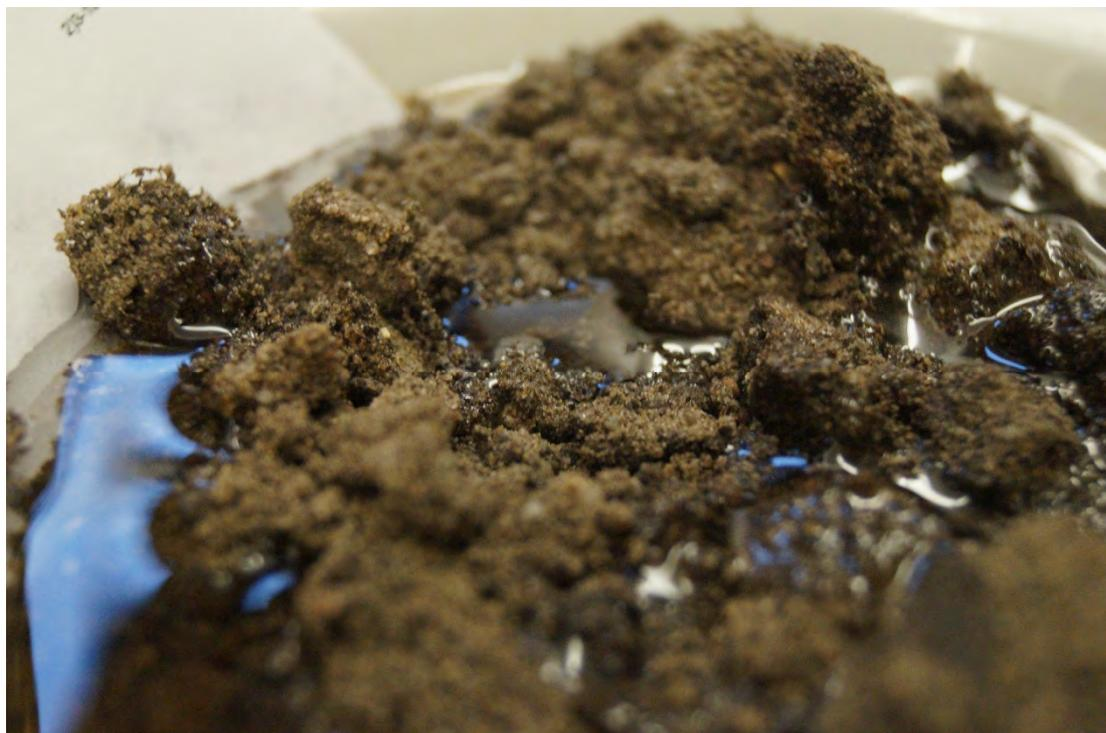
Bild 16) RTS B2, Wässerung nach Trocknung, hydrophobe Wirkung der Organik
