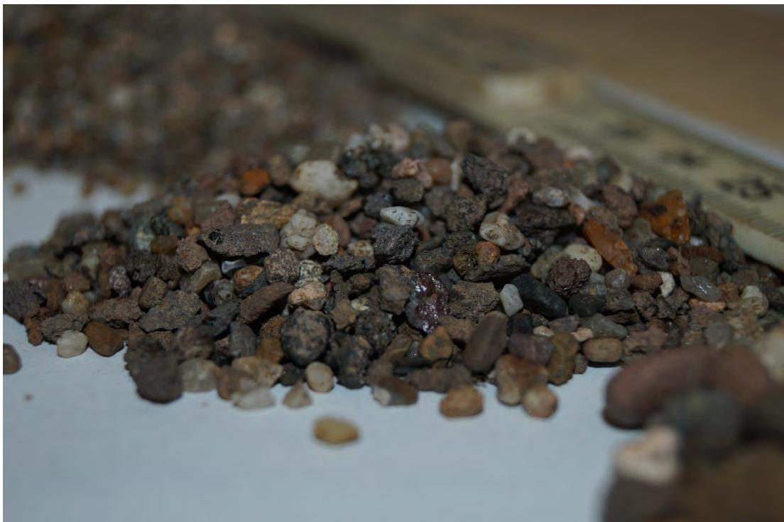
Bild 11) Fraktionierung Rasentragschicht B1 (oberer Horizont) Korngröße 2 – 4 mm
