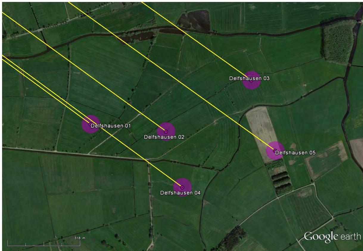
Abbildung 3: Detailübersicht der geplanten Windenergieanlagen (magenta). Die Einstrahlungsrichtungen bzgl. der Radaranlage Wittmund sind gelb dargestellt.
