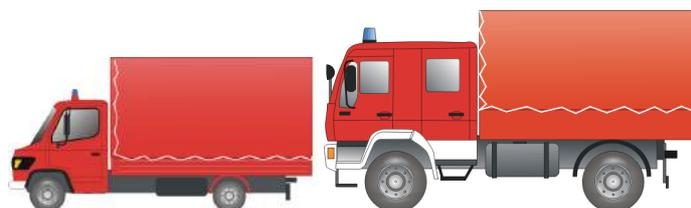
Fahrzeug für den Materialtransport, häufig in Ausführung als Kleintransporter mit Pritsche (ggf. mit Plane und Spriegel) oder als Lkw mit Kastenaufbau, wobei der GW-L2 den bisherigen Schlauchwagen SW 2000 ersetzt.
