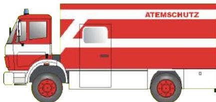
Lkw mit Kastenaufbau zum Transport von Atemschutzgeräten an die Einsatzstelle. Auf dem Fahrzeug sind auch Chemikalienschutzanzüge verlastet.
