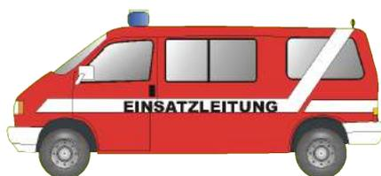
Fahrzeuge der Einsatzleitung, die insbesondere mit Informations- und Kommunikationsmitteln (Alarm- und Einsatzpläne, Gefahrstoff-Nachschlagewerke, Telefon, erweiterte Funkausrüstung, ggf. Fax, PC mit Datenbanken) ausgerüstet sind. Typen
