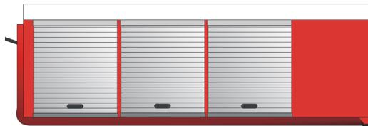
Abrollbehälter mit spezieller Ausrüstung für einen Gefahrguteinsatz, u. a. für besondere Schutzausrüstung der Einsatzkräfte, Gerätschaften zum Aufnehmen und Auffangen von gefährlichen Stoffen.
