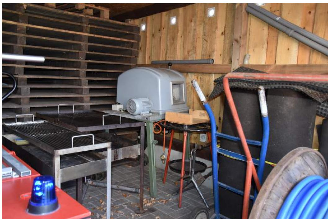
Abb. 7.3-28: OF Loy-Barghorn: Alte Schlauchwaschanlage in der Kaltgarage
