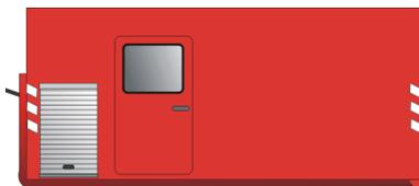
Abrollbehälter mit einem Aufenthaltsraum. Der Raum kann als Besprechungsraum für Lagebesprechungen, als Verpflegungsraum zur Nahrungsaufnahme oder als Ruheraum für Einsatzkräfte genutzt werden.
