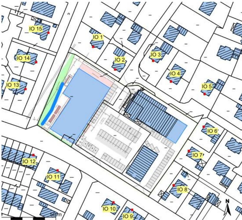
Abbildung: Lageplan der Schallimmissionsprognose
