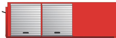
Abrollbehälter mit einem Wassertank und Geräten zur Wasserförderung, je nach Beladung mit einem Fassungsvermögen von 8.000 l oder mehr.
