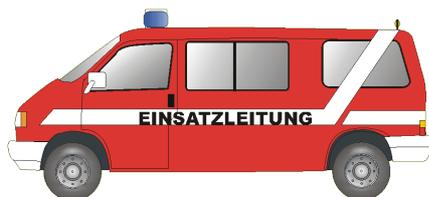
Fahrzeuge der Einsatzleitung, die insbesondere mit Informations- und Kommunikationsmitteln (Alarm- und Einsatzpläne, Gefahrstoff-Nachschlagewerke, Telefon, erweiterte Funkausrüstung, ggf. Fax, PC mit Datenbanken) ausgerüstet sind. Typen
