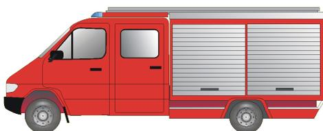
Fahrzeug mit feuerwehrtechnischer Beladung für eine Gruppe. Ein TSF wird vornehmlich zur Bekämpfung kleinerer Brände eingesetzt. Die Besatzung beträgt 1/5.
