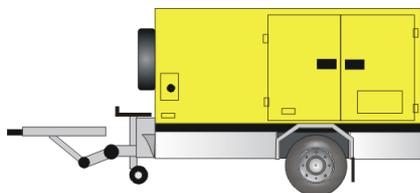
Anhänger mit einem Stromerzeuger zur Versorgung von Einsatzstellen mit elektrischer Energie.
