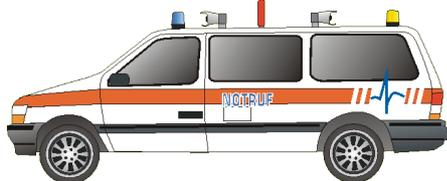
Pkw (Kombi) als Fahrzeug zur Zubringung des Notarztes, der im Rendezvous-Verfahren an der Einsatzstelle den RTW ergänzt. Das Fahrzeug ist mit der vollständigen Ausrüstung für die Notfallmedizin ausgestattet, jedoch nicht zum Transport von Patienten einsetzbar.
