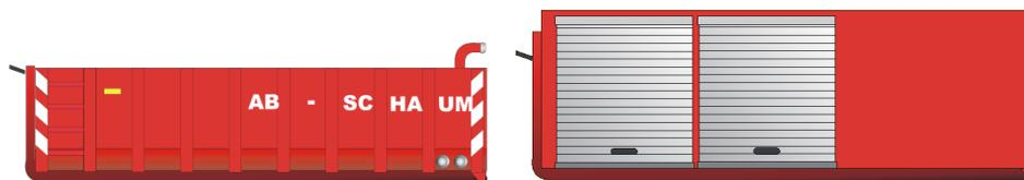
Austauschbarer Aufbau für Wechselladerfahrzeuge. Ein AB kann ein kastenförmiger Container, ein Pritschenaufbau, eine Kippmulde o. ä. sein. Abrollbehälter können in kürzester Zeit vom Fahrzeug auf- bzw. abgesattelt werden. Abrollbehälter finden dann Verwendung, wenn wegen geringer Einsatzfrequenz die Beschaffung eines jeweils hierfür spezialisierten Fahrzeugs nicht angezeigt ist, die Mittel aber dennoch vorgehalten werden müssen.
