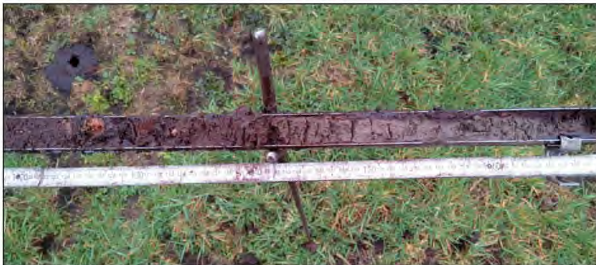
Abbildung 85: Bohrkern bei BP 131, braune bis graue Schluffmudde ab 1,42 cm Tiefe, links davon Niedermoortorf
