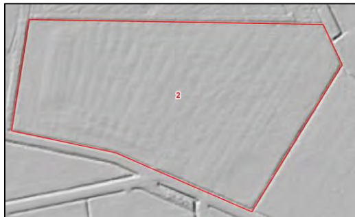
Abbildung 12: Hillshade-Modell (Schummerung) mit erkennbarem Verlauf der Drainage.
