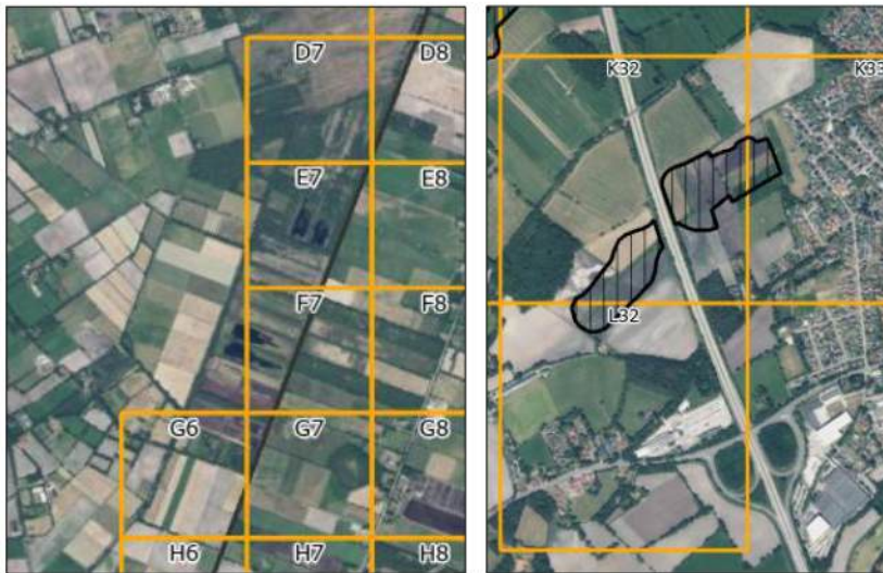
Abbildung 7: Gitterzellen am Bohrkulissenrand. Links: Die Gitterzellen G6 und D7 liegen zum Großteil im Landkreis Leer. Rechts: Die überwiegend in K32 gelegenen Flächen werden durch zwei Bohrpunkte ausreichend repräsentiert. Der dritte Bohrpunkt wurde in eine andere Gitterzelle verschoben. Dieses Beispiel zeigt auch die Notwendigkeit des manuellen Verschiebens der im Zentrum der Gitterzellen im GIS automatisiert geplanten Bohrpunkte.
