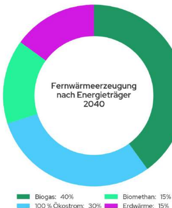
Abbildung 49: Fernwärmeerzeugung nach Energieträgern im Zieljahr 2040 in Rastede
