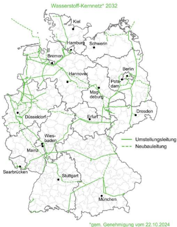
Abbildung 33: Übersicht Wasserstoff-Kernnetz in Deutschland
