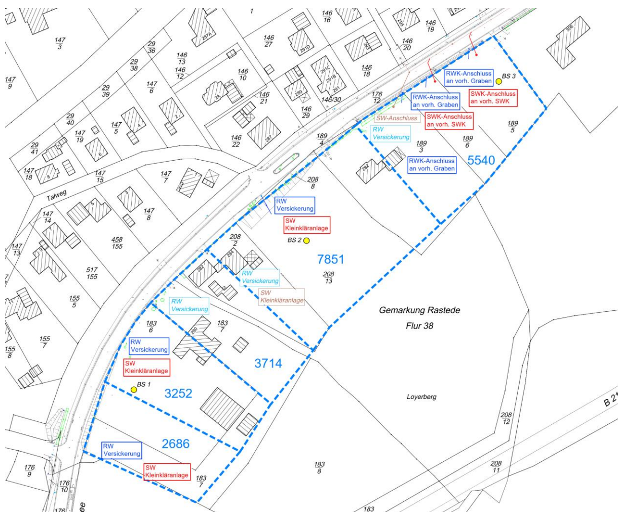
Abbildung 8: Entwässerungskonzept, Quelle: Ingenieurbüro Horst Prante
